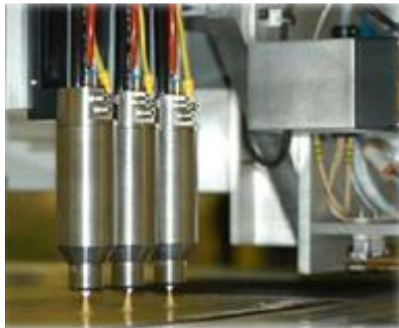
Imagen 8. Equipo de plasma de tratamiento superficial
