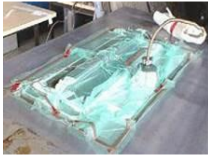
Imagen 4. Fabricación de pieza por infusión. AIRBUS
